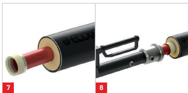
Si procede quindi ad innestare il raccordo, inserendo il collegamento nell'attrezzatura di compressione e giuntando il collegamento esercitando pressione.
