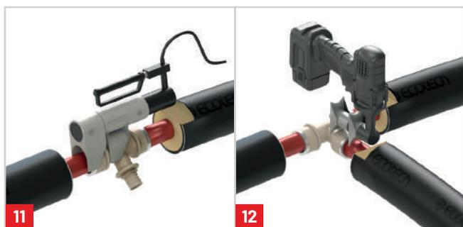
Completata la giunzione tra le tubazioni, si procederà alla muffolatura ed al ripristino dell'isolamento in corrispondenza della giunzione come indicato nel paragrafo relativo.
